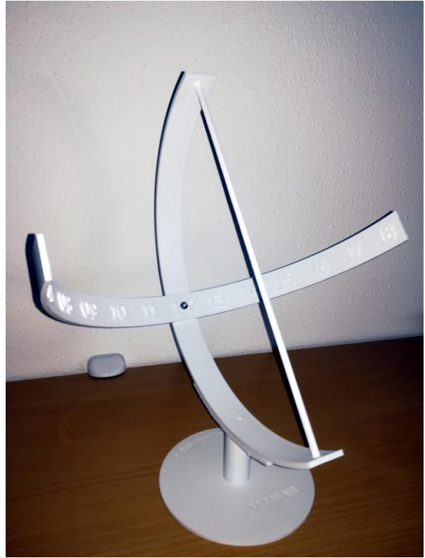
Onderdelen worden op de 3D printer gemaakt met bovenstaand resultaat.
